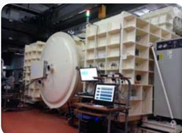
圖5、R2R電弧PVD系統
