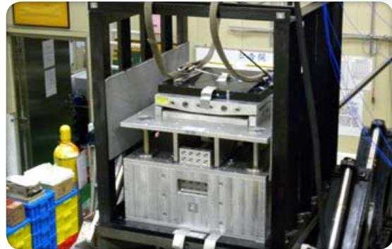
圖2、地震測試台測試之隔震器裝置
