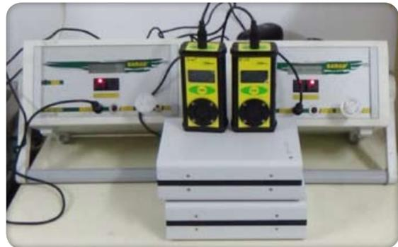
圖4、氡氣量測儀器
