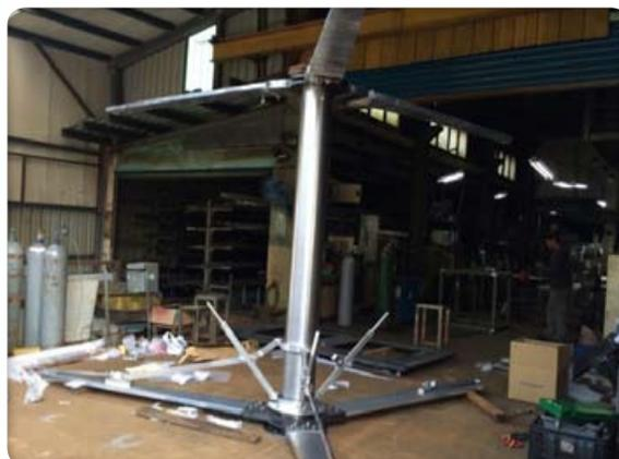
圖1、5 kW垂直軸風機地面組裝
