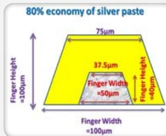
圖2、指狀電極結構
