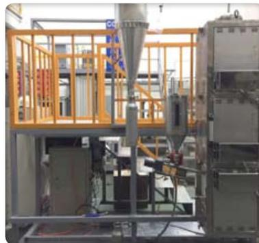
圖3、中高溫酸性氣體移除反應系統
