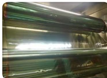
圖6、TiO<sub>2</sub>/Ag/TiO<sub>2</sub>/Ag/TiO<sub>2</sub>之Low-E節能膜產品
