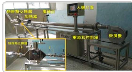
圖2、熱管熱交換器測試與展示系統
