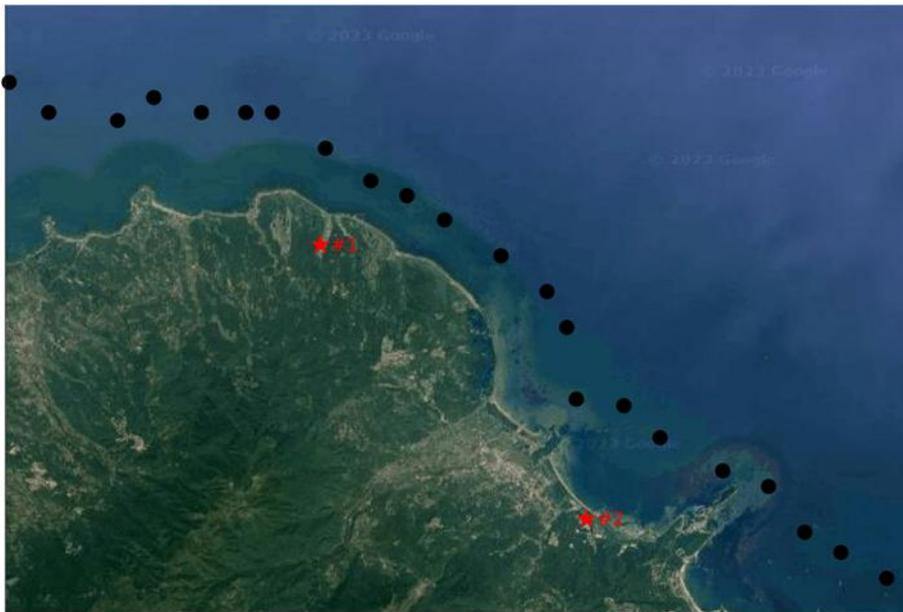
圖 2-4-3 沸水式核電廠 #1 和 #2 外海 50 m 水深的單位海嘯法接收點位置
