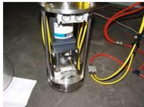
中央實驗管鑽孔取樣機無殼式過濾單元製作與運轉測試
