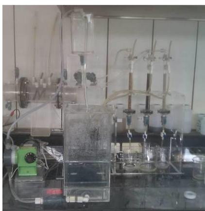
吸附劑效能測試管柱式吸附實驗裝置
