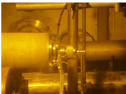
粉末外罐封罐銲接與抽氣作業
