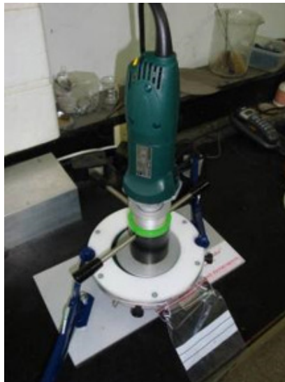
混凝土耐久性試驗(氯離子)-粉末採樣研磨機
