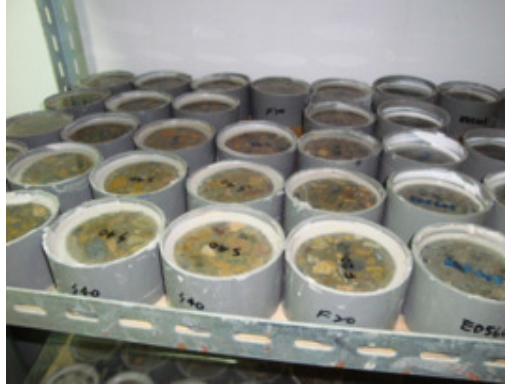
混凝土耐久性試驗(氯離子)-試體浸泡前置圖
