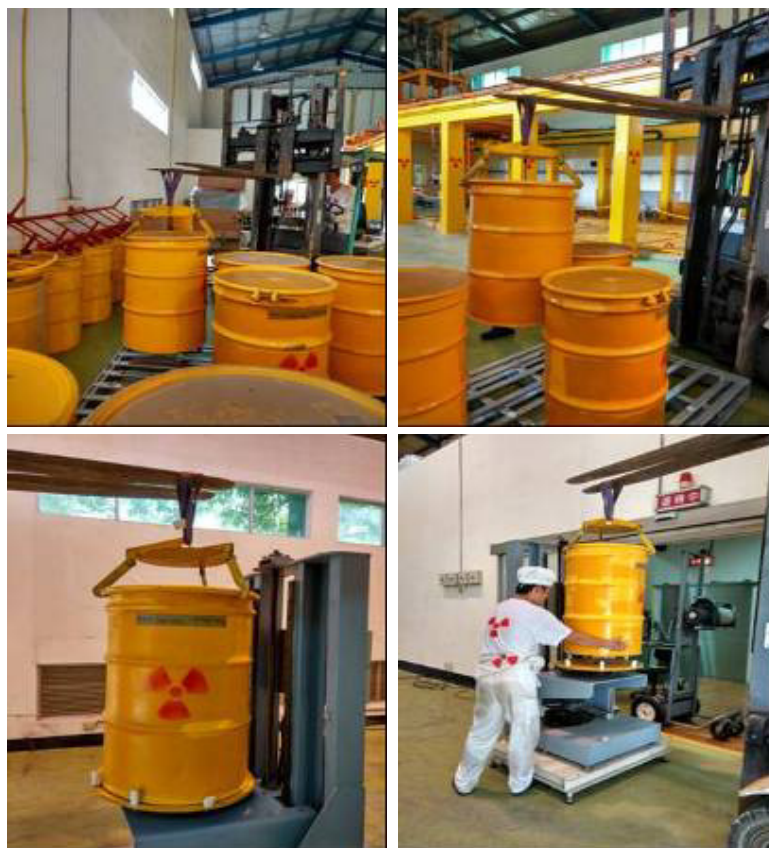
小産源廢棄物現場整桶計測設備建立測試
