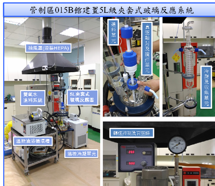
015B 館建置 5 公升級夾套式玻璃反應槽、冷凝、溫控、連續進料及攪拌單元
