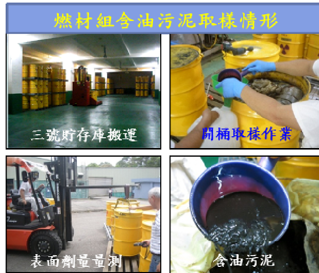
含油污泥開桶取樣作業情形
