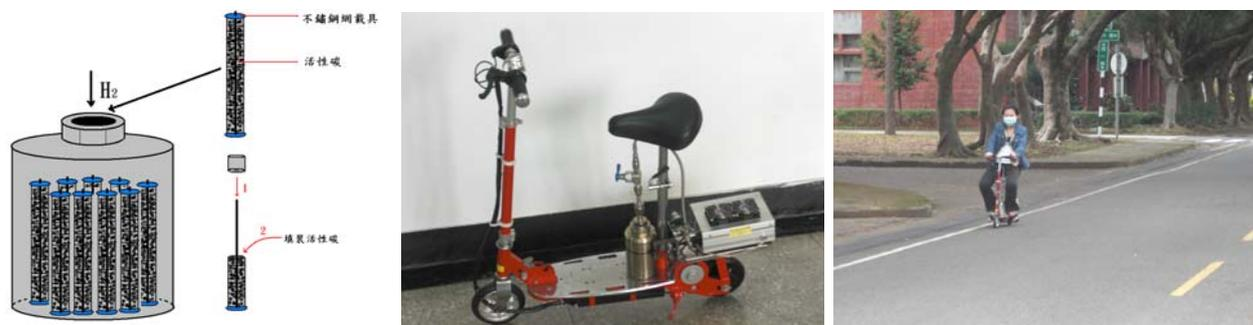
圖 7. 儲氫材料應用於 150 W 儲氫匣運作系統測試
