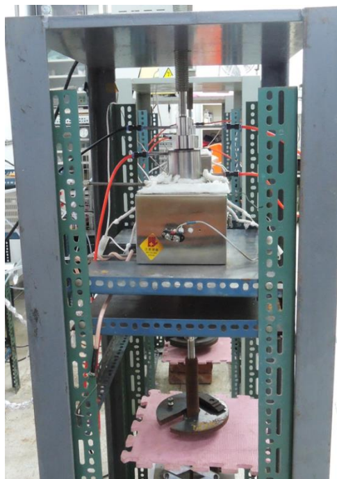
圖七、潛變試驗之實驗裝置
