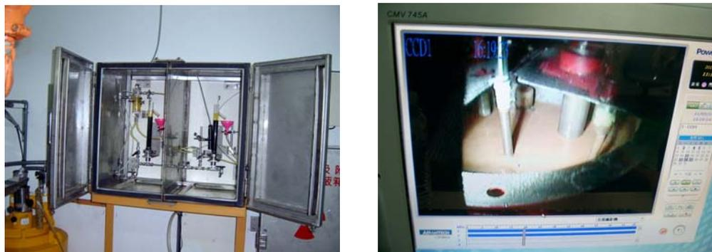
圖一、強酸廢液處理設備新增 Cs-137 及 Sr-90 吸附管柱、攝影監視器裝置
