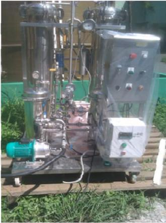
AC-5B用於洗滌廢液現場吸附測試結果
