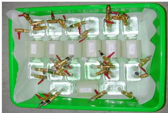
圖一、非放射性 100 ppm Cs 核種擴散實驗
