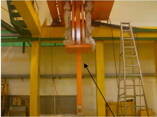
圖一、地下庫高活度放射性廢棄物天車遙控多節式抓取裝置
