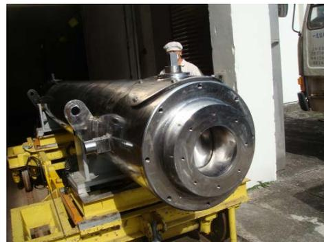
圖三、粉末外罐移貯貯存護箱作業
