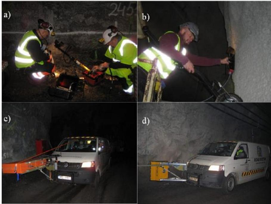
圖D-2 POSIVA 於 ONKALO 進行的 EDZ 先導試驗。其採用之 GPR 量測系統：(a) GSSI SIR-2000 搭配 400 MHz 天線及(b) 1500 MHz 天線、(d) GSSI SIR-20 搭配 1 GHz 及 2.2 GHz 天線及(e) 3D-Radar Geoscope 搭配多頻道天線(POSIVA, 2008)
