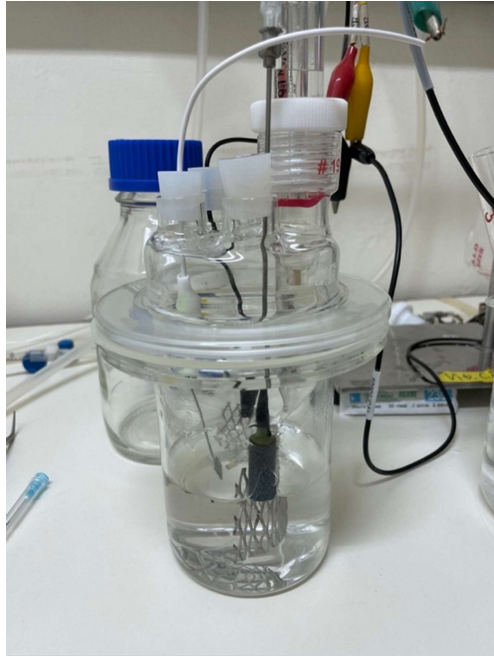
圖 5、電化學分析槽
