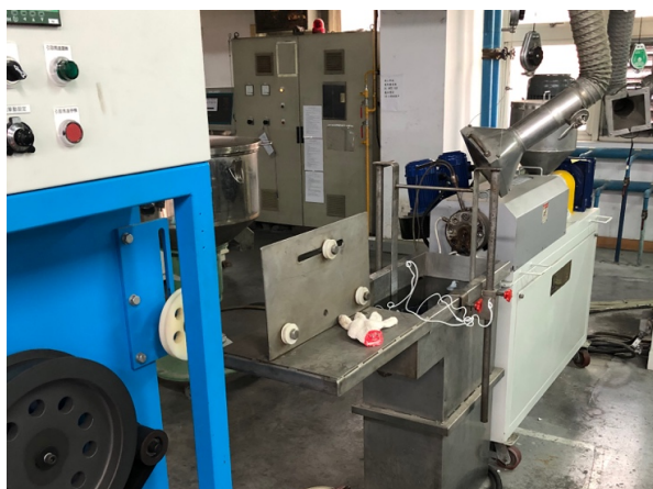
圖十四、單螺桿押出機+膠條牽引及收卷
