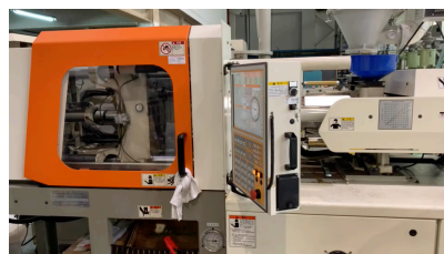
符合ASTM檢測規範之PHA試片射出
