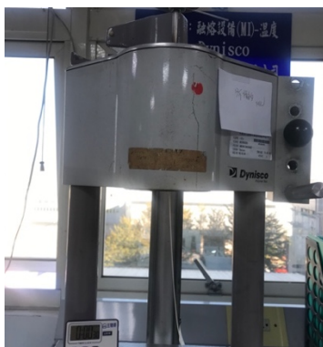
圖八、熔融指數儀檢測
