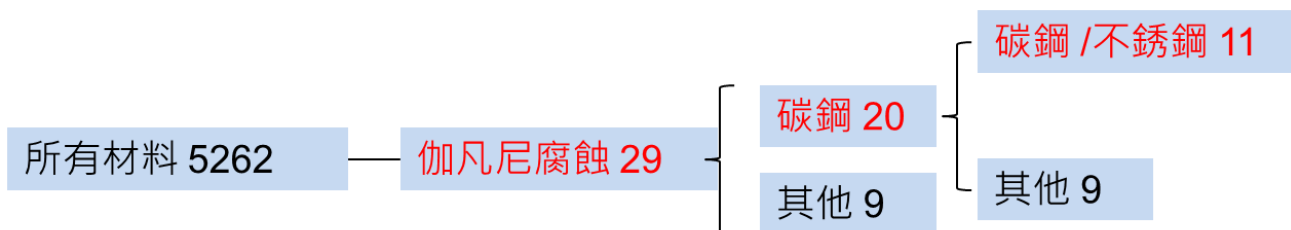
圖 6 伽凡尼腐蝕案例整理
