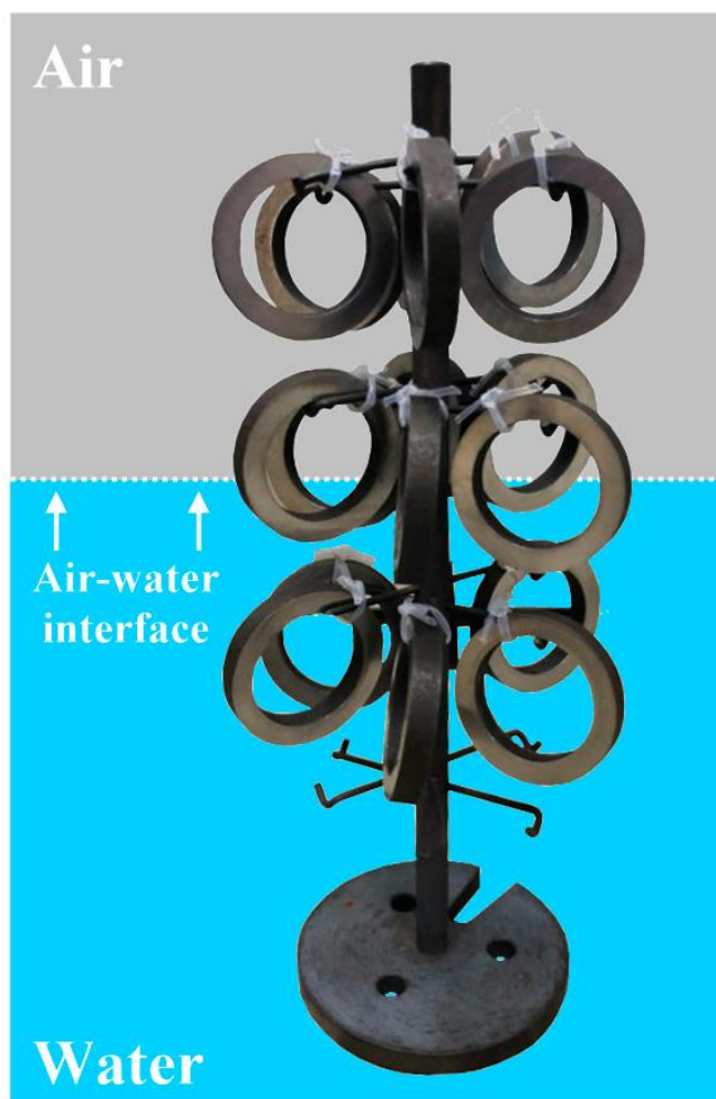
圖 2 實驗(3) 試片擺放示意圖
