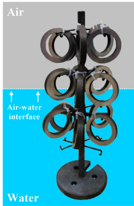
圖 10 實驗 3 試片擺放示意圖
