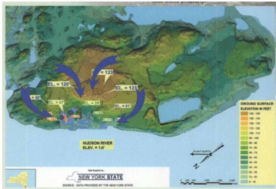
圖 2-4 廠址地下水流動之概念模型[7]
