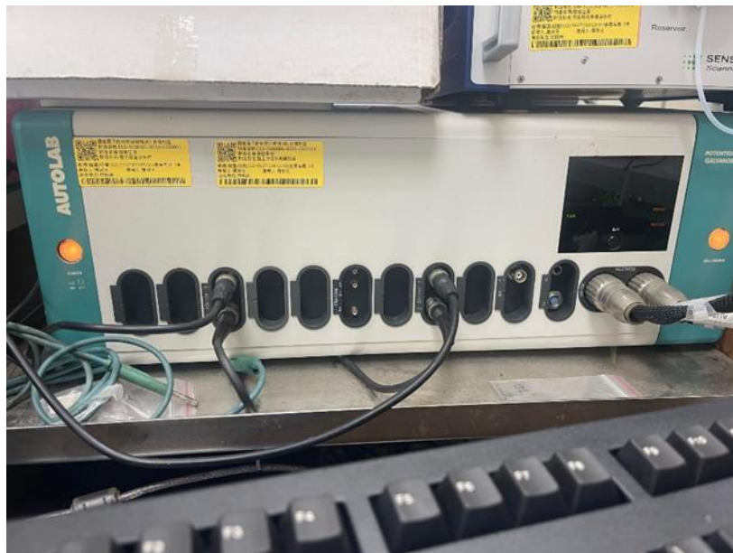
圖 37 恆電位儀 AutoLab PGSTAT 30
