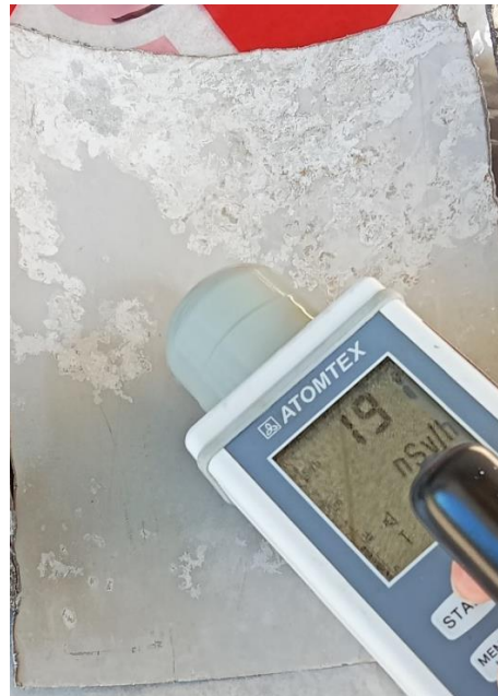
圖 3.11 小產源廢金屬(a)原樣品 C 外觀、(b)除污後樣品 C'外觀、(c)原樣品 C 輻射劑量率與(d)除污後樣品 C'輻射劑量率
