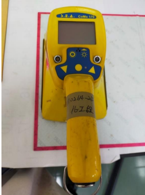
圖 3.3 表面輻射污染偵測儀(S.E.A. CoMo 170)
