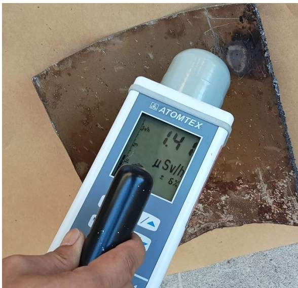
圖 3.12 小產源廢金屬(a)原樣品 D 外觀、(b)除污後樣品 D'外觀、(c)原樣品 D 輻射劑量率與(d)除污後樣品 D'輻射劑量率
