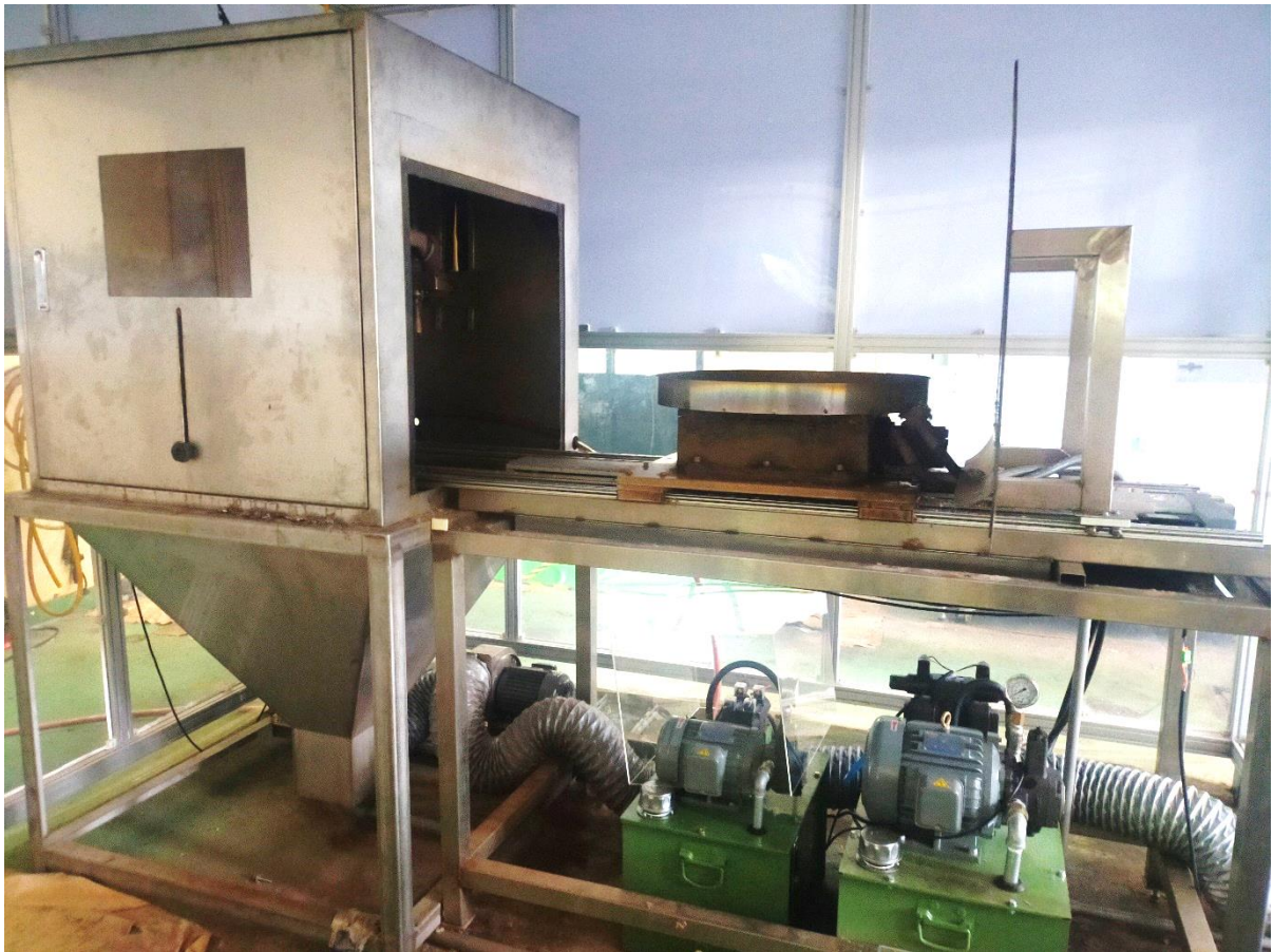
圖 4.10 本院之半自動高壓水除污設備
