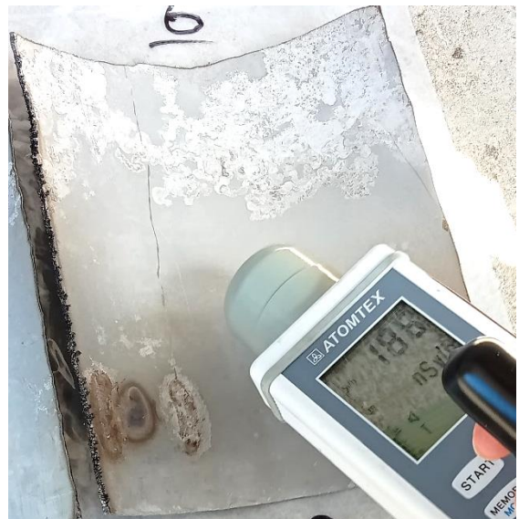
圖 3.12 小產源廢金屬(a)原樣品 D 外觀、(b)除污後樣品 D'外觀、(c)原樣品 D 輻射劑量率與(d)除污後樣品 D'輻射劑量率
