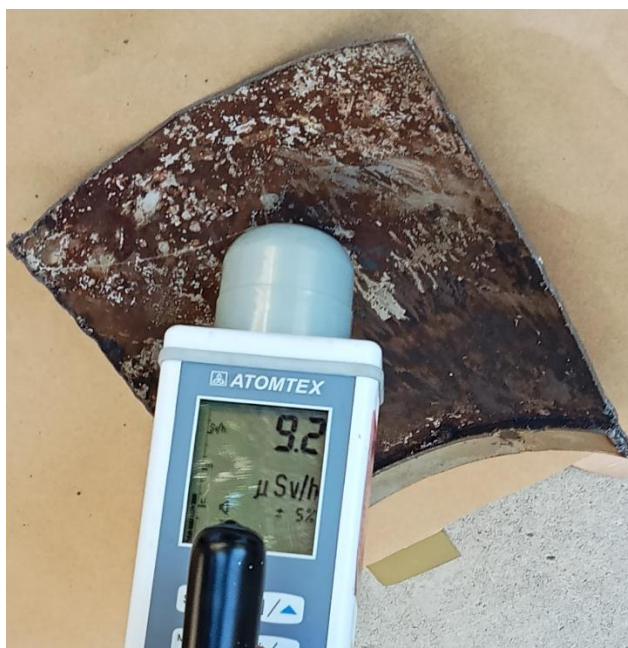
圖 3.10 小產源廢金屬(a)原樣品 B 外觀、(b)除污後樣品 B'外觀、(c)原樣品 B 輻射劑量率與(d)除污後樣品 B'輻射劑量率
