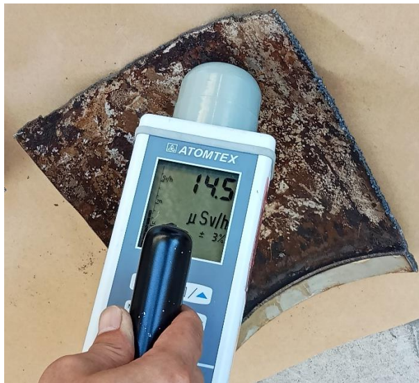
圖 3.9 小產源廢金屬(a)原樣品 A 外觀、(b)除污後樣品 A'外觀、(c)原樣品 A 輻射劑量率與(d)除污後樣品 A'輻射劑量率
