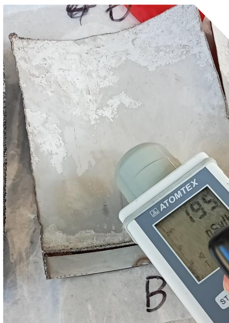
圖 3.10 小產源廢金屬(a)原樣品 B 外觀、(b)除污後樣品 B'外觀、(c)原樣品 B 輻射劑量率與(d)除污後樣品 B'輻射劑量率
