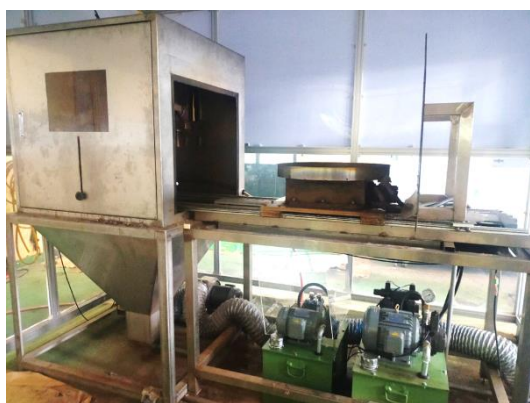
圖 1 本院之半自動高壓水除污設備
