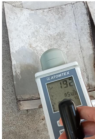
圖 3.9 小產源廢金屬(a)原樣品 A 外觀、(b)除污後樣品 A'外觀、(c)原樣品 A 輻射劑量率與(d)除污後樣品 A'輻射劑量率
