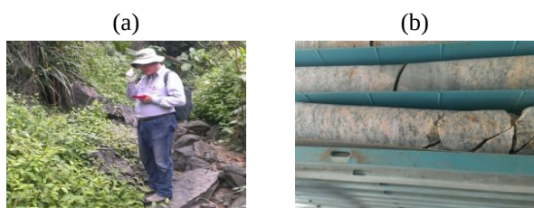
圖 1、臺灣本土母岩：(a)台東硬頁岩，(b)金門花崗岩。
