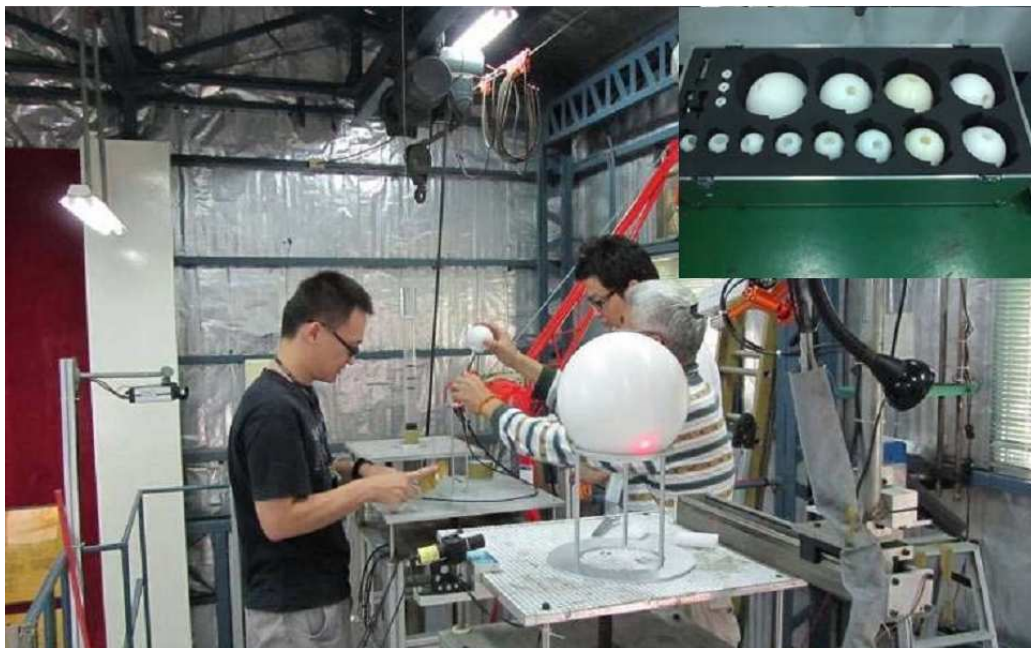
多球式中子能譜量測系統之 PE 緩速球及實驗量測設計
