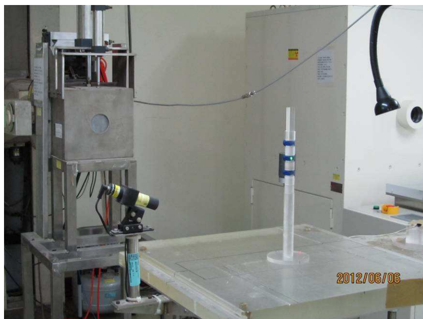
指環劑量計劑量校正假體設計與劑量照射
