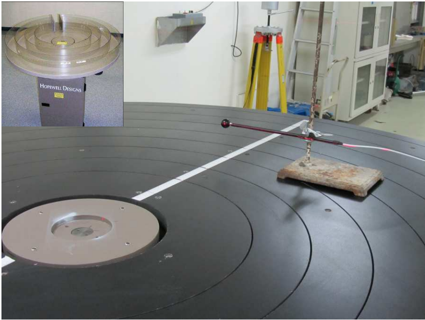
圓盤式環境劑量計 Cs-137 加馬照射器輻射劑量標定
