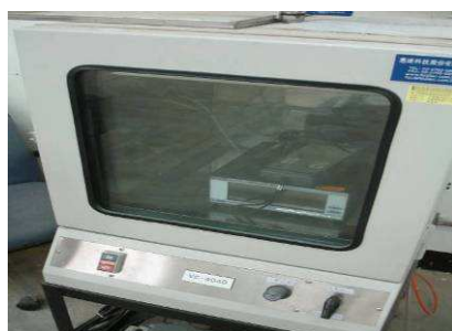
耐大氣壓力測試
