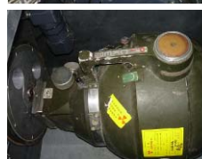
^{60}\text{Co} 廢射源再生利用之照射系統進行性能測試與輻射劑量標定
