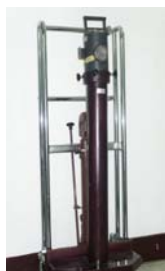
環境劑量 HPIC 監測器之現場遊校(輔助設備：雷射測距儀與射源高度升降機)
