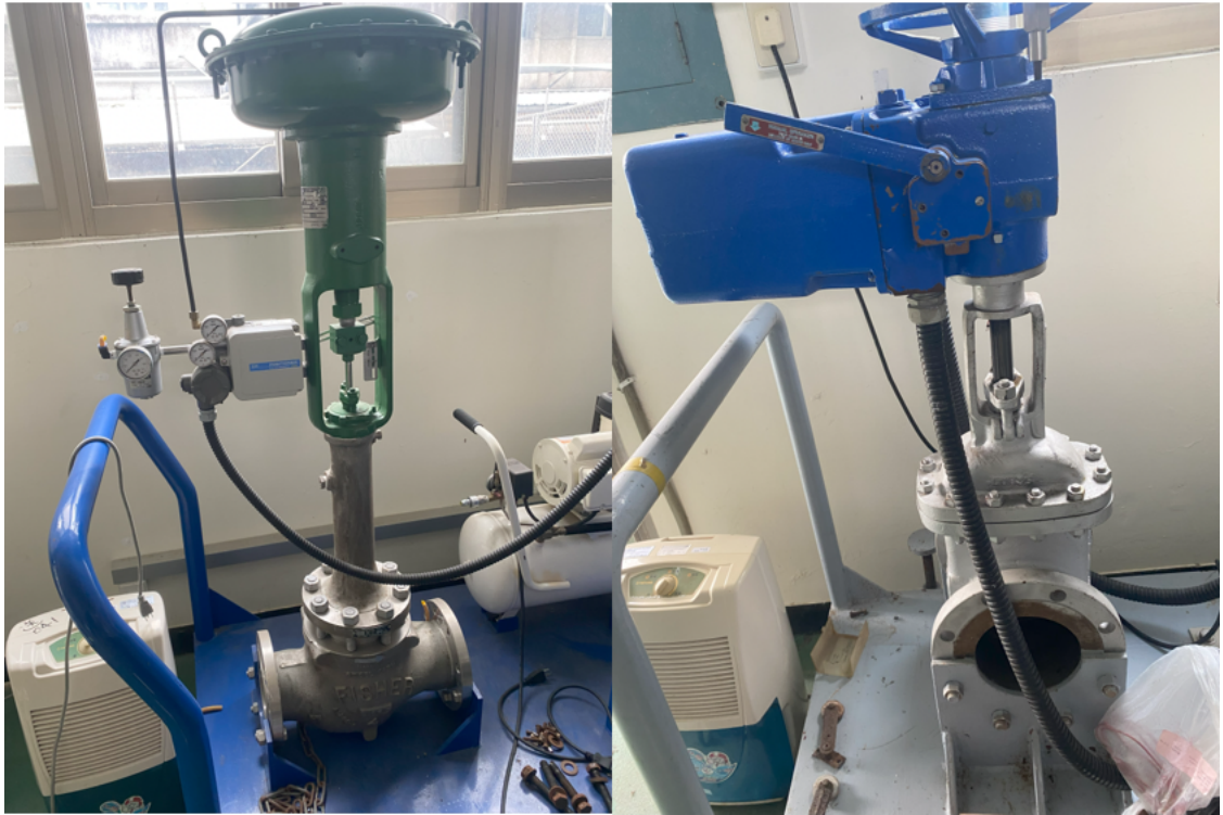
圖二-1 氣動止迴閥(左)與電動閘閥(右)
