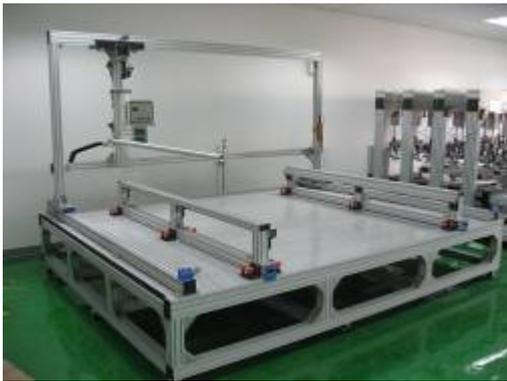
圖 7：冰電衝擊測試平台
