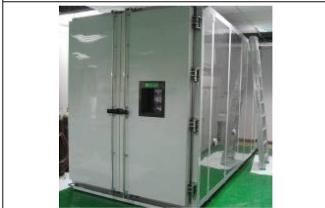
圖 5：大型溫濕循環測試平台
