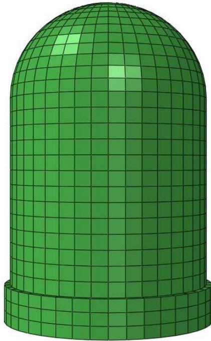
圖 3-144 馬鞍山核電廠圍阻體有限元素模型(許皓程，2018)
