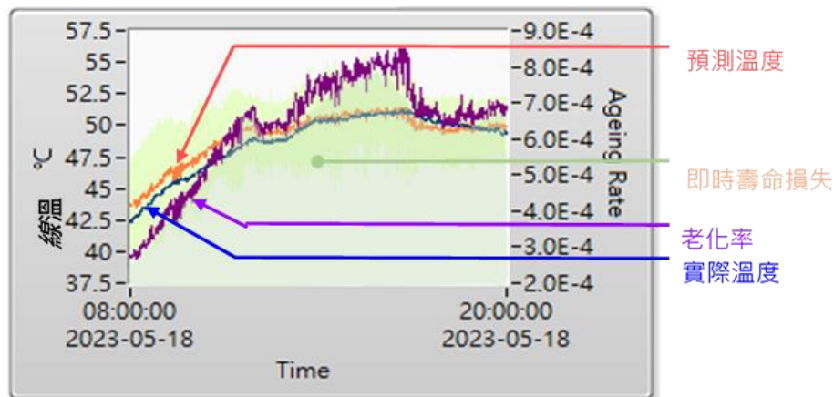
圖 82 供電變壓器熱點溫度之故障損傷程度診斷模組介面
