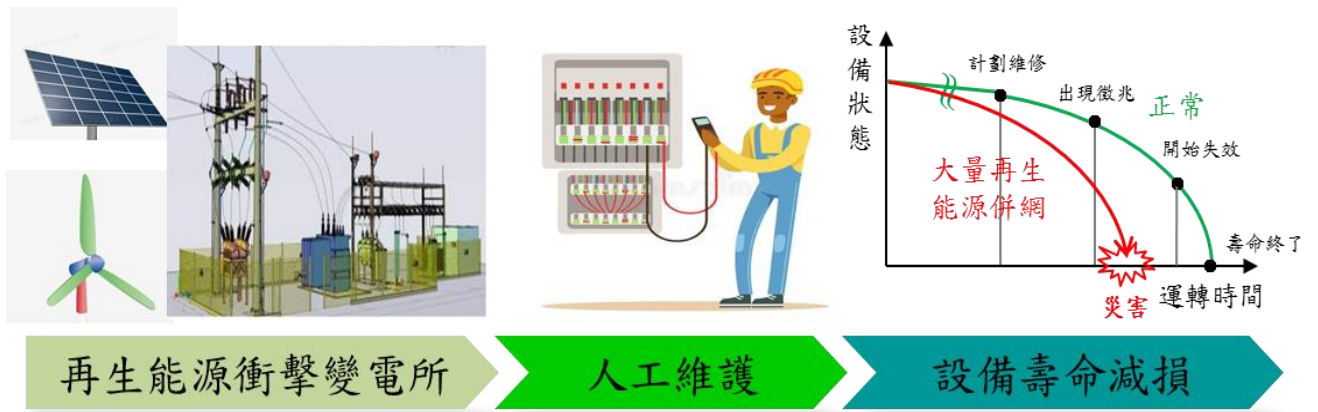
圖 6、大量再生能源併網所導致變電所設備壽命減損
