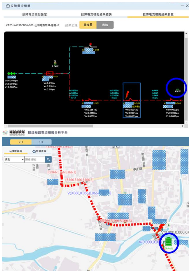
圖 50、再生能源與儲能之故障電流計算的地理空間資訊平台
