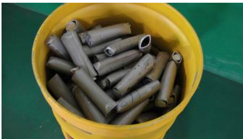
乏燃料套管切割後裝桶照片
