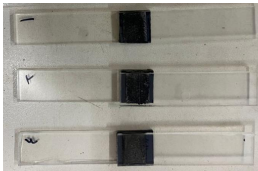
圖 16. ABS 板材於雷射接合成品圖
