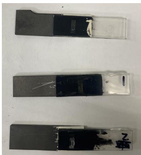
圖 21. ABS 板材與石墨板於雷射接合成品圖
