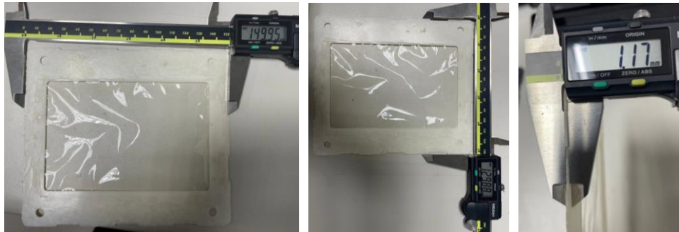
圖 25. 質膜蓋板超音波接合成品圖
