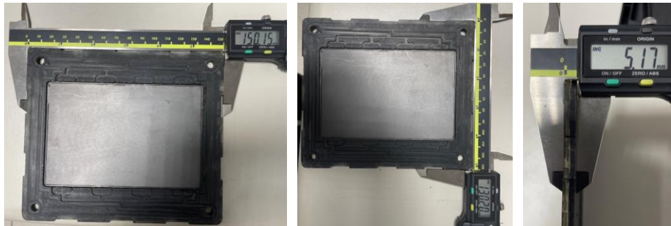
圖 23. 串聯框體雷射接合成品圖
