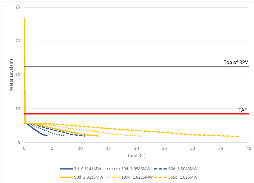
圖 3.1.31 LOCA 事故下，不同停機冷卻時間案例之水位變化圖
