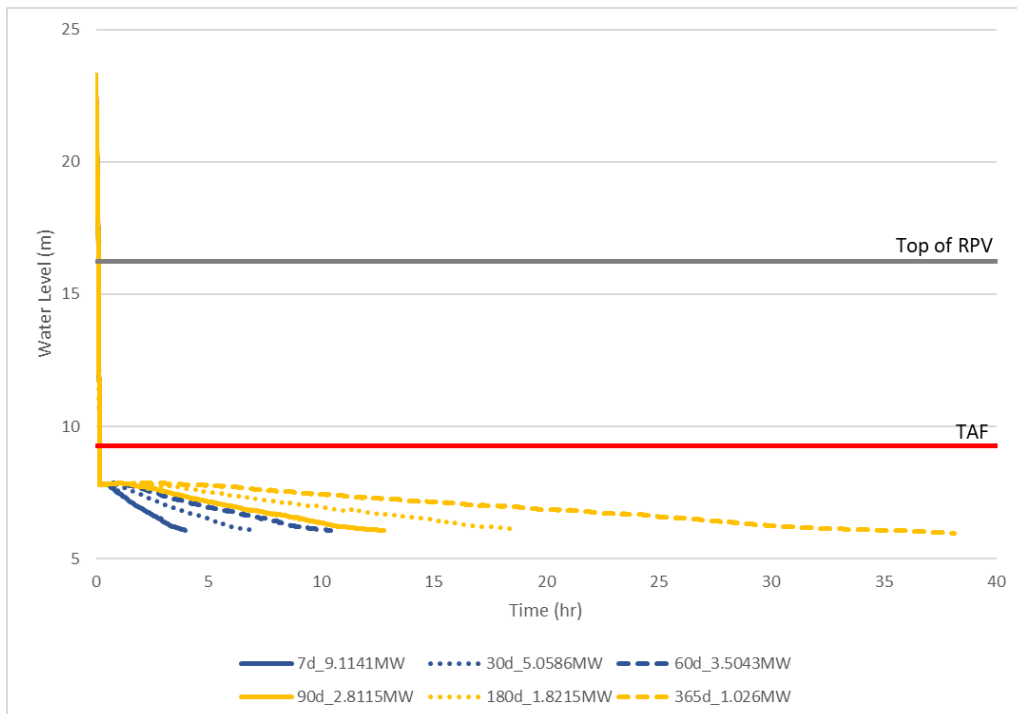
圖 3.1.38 TRACE 程式計算案例七至案例十二水位變化圖
