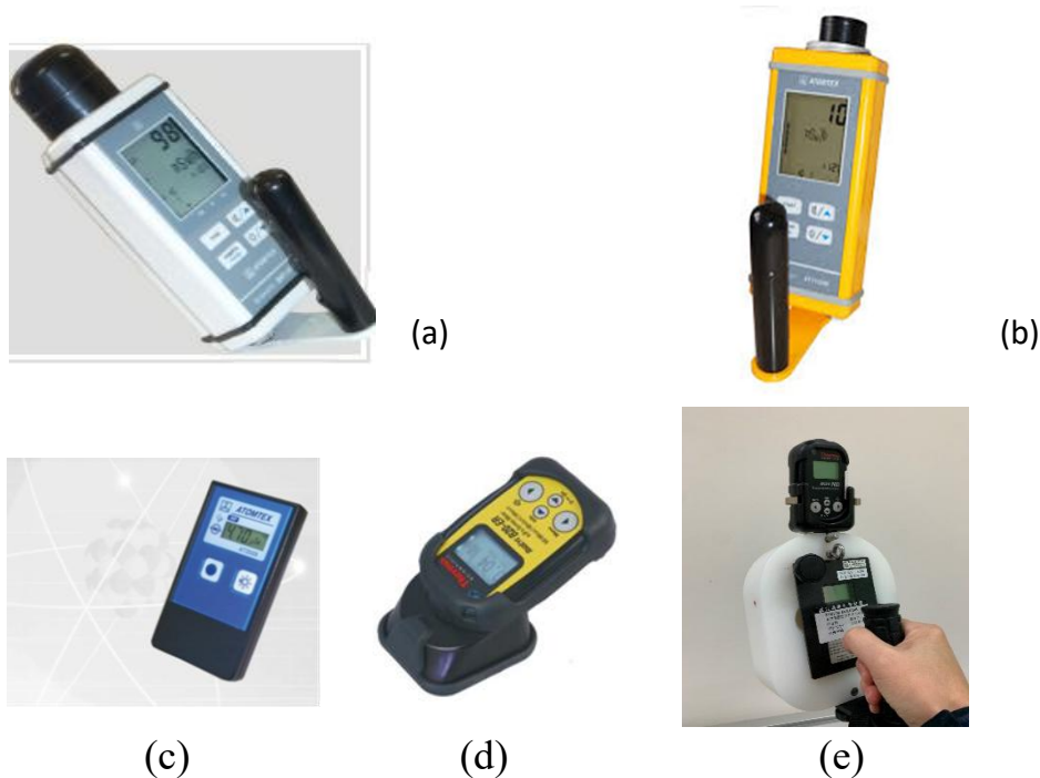
圖 1. 計畫執行現場訪查之輻射偵檢儀器設備：(a) Atomtex AT1121, (b) Atomtex AT1103M, (c) Atomtex AT3509B, (d)Thermo RadEye B20, (e) Thermo RadEye NL。
