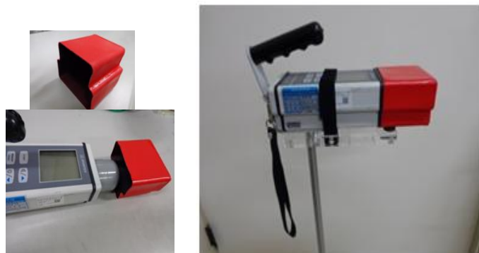
圖3. 模擬協助者穿著鉛衣之等效鉛(0.5 mm Pb eq)套筒(左上)、 包覆鉛套筒位置示意圖(左下)，及以完成包覆後之偵檢器及 鉛套筒照片(右)。
