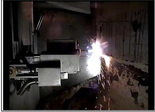
圖 3- 11 RPV 遠端遙控熱切割
