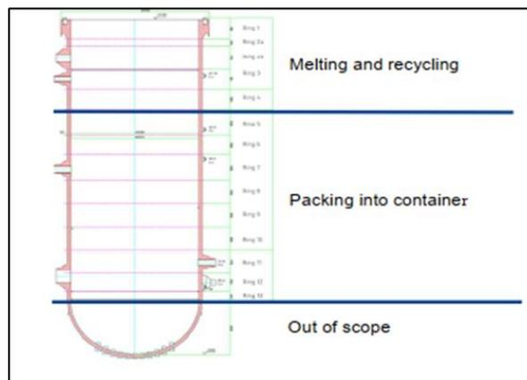
圖 3- 21 Würgassen RPV 切片的分類
