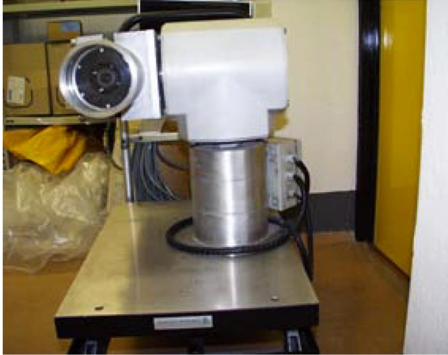
圖 2-19 斯洛伐克 A-1 核電廠除役計畫中使用的 ALADIN 相機
