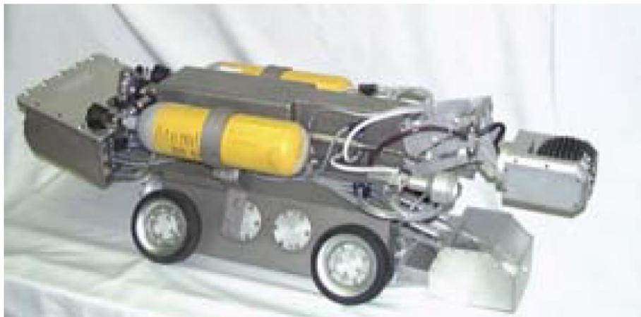
圖 2- 7 捷克共和國使用的 PCK-60 型管路檢查及拆除台車
