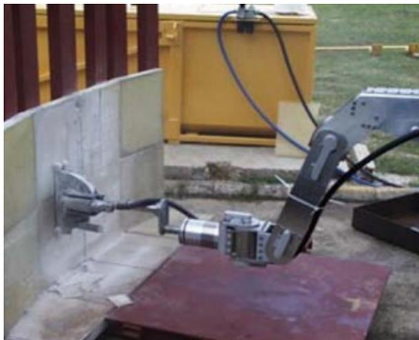
圖 2- 34 地下儲槽切割模擬測試
