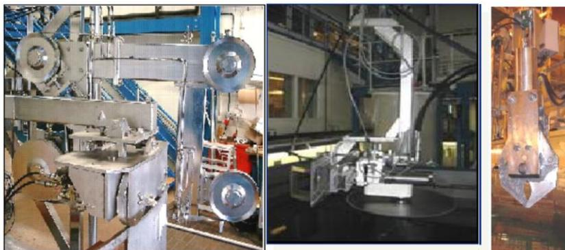
圖 3- 30 切割過程中所使用的設備，由左至右為：帶鋸、圓盤鋸、液壓剪
