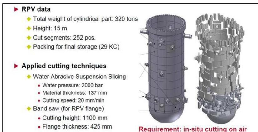
圖 3- 19 Wüergassen NPP 之 RPV 的拆解
