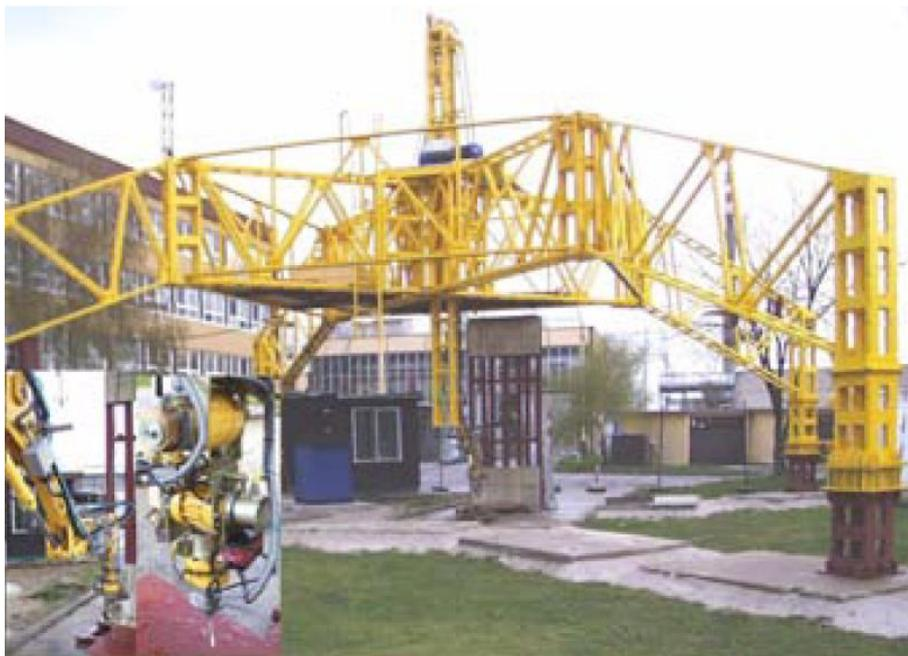
圖 2- 21 DENAR 機械手臂在模型測試期間完全組裝(斯洛伐克)
