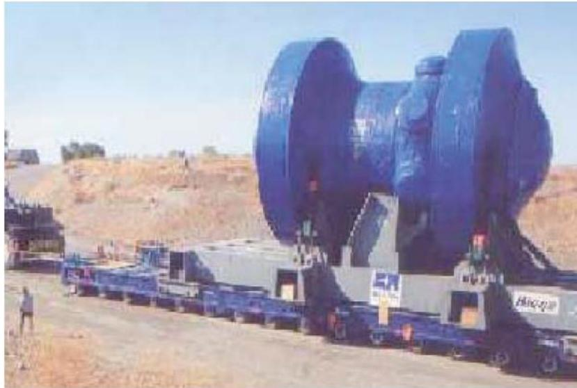
圖 3- 54 RPV 在運輸過程中的展示，配備輻射防護罩和減震器。
