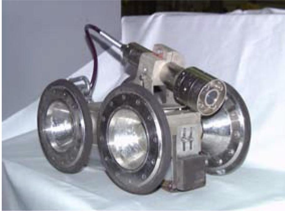
圖 2- 6 捷克共和國使用的 PVK-3 型管路輻射特性調查台車
