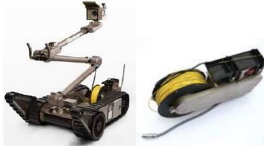
圖 1- 6 Packbot 510 機器人與卷軸器 [4]
