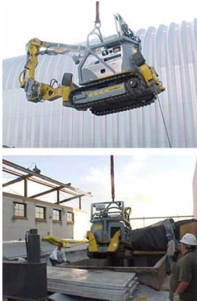
圖 2- 15 將遠端操作拆卸裝置(BROKK)，放入美國紐約州布魯克海文 (Brookhaven)的 BGRR 管路中
