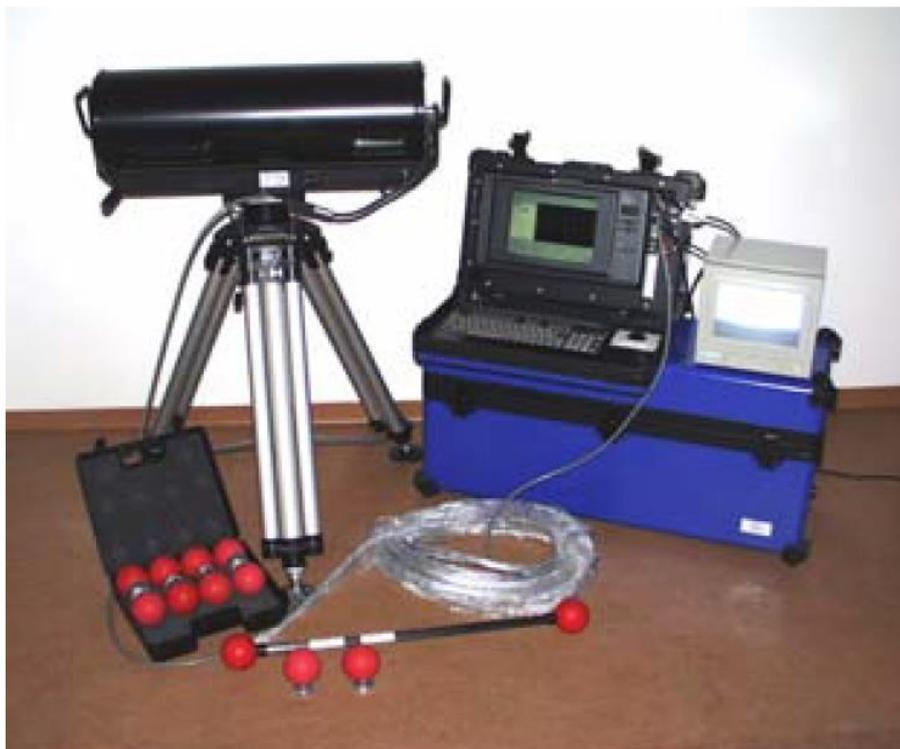
圖 2- 17 斯洛伐克 A-1 核電廠除役計畫所使用的 3D 雷射掃描儀
