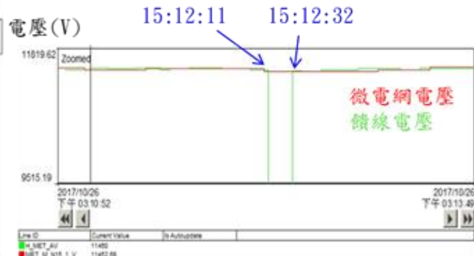
高壓微電網與饋線電壓
