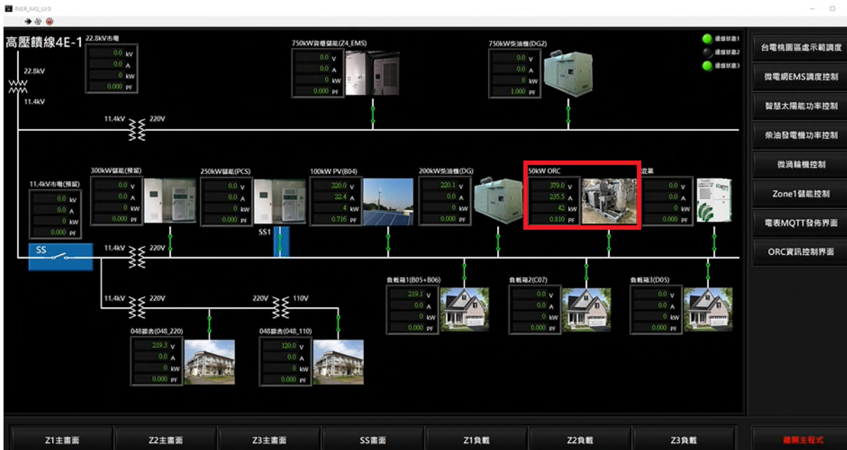
圖 5-8、完成 50kW 熱電能轉換模組與微電網能源管理系統之整合測試
