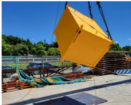
圖 2-4：C3 容器角墜落試驗
