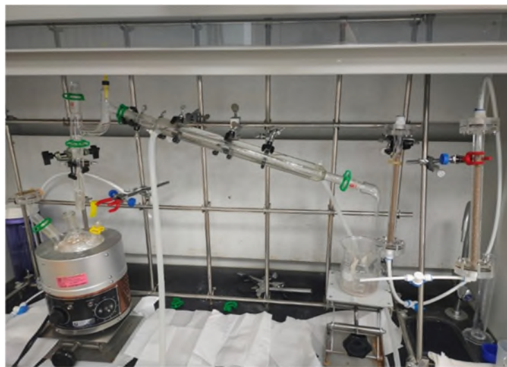
圖 2-12：實驗室蒸發串接離子交換管柱設備
