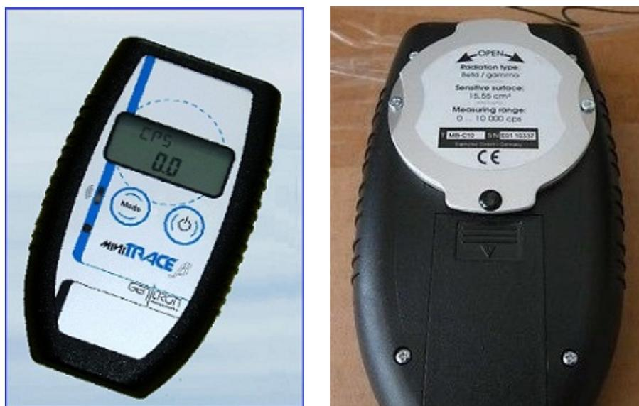
放射活度  $\alpha/\beta$  污染偵測儀器 MiniTRACE/C10/ PR 302664
