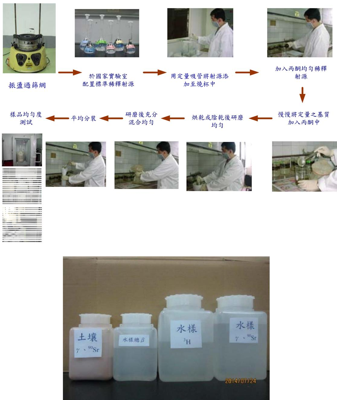
圖 2.1 參考物質試樣配製流程
