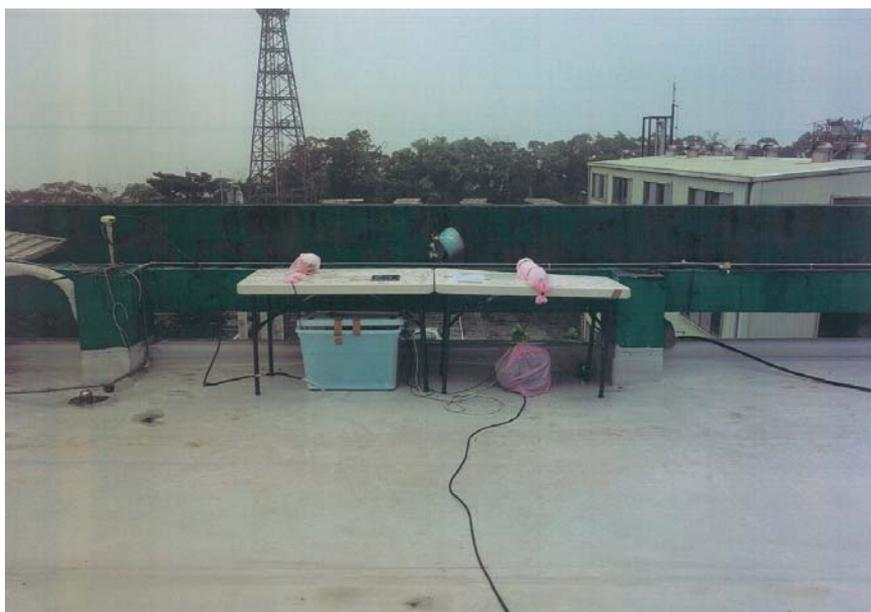
圖 5.3 核研所背景區宇宙射線誘發中子能譜量測實驗
