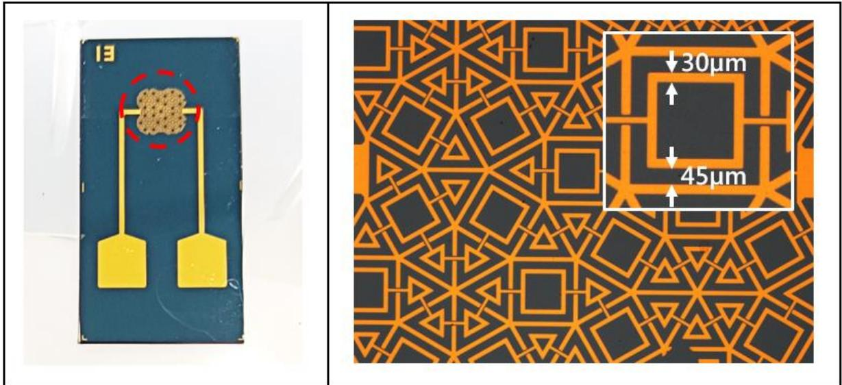
圖 4-18 (左)感測電路實體，尺寸 20mm x 10 mm，感測區域(紅框區域)3mm x 3mm；(右)感測電路之光學顯微鏡放大影像。
