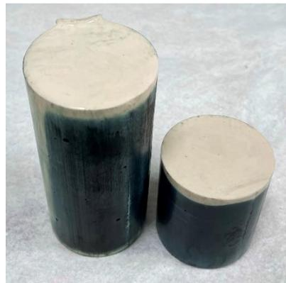
圖 2-16 廢油泥模擬物初步安定化測試
