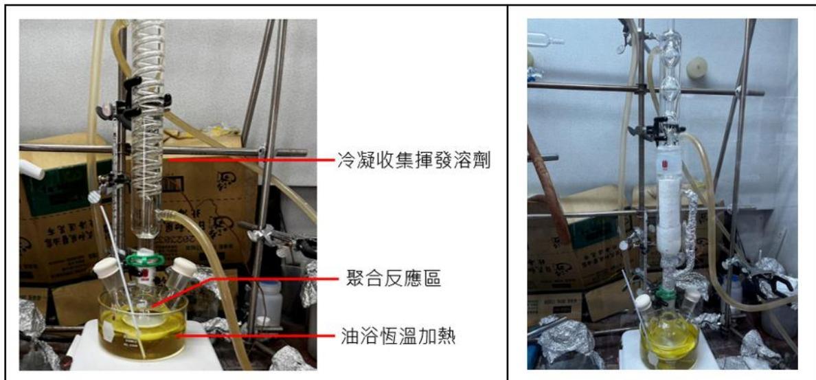
圖 4-15 (左)分子印刷高分子聚合實驗架設，將 CTx-1(模板分子)溶於乙腈中以超音波震盪加速混合，待均勻再加入甲基丙烯酸(功能性單體)、偶氮二異丁腈(起始劑)、乙二醇二甲基丙烯酸酯(交連劑)，通入氮氣並加熱反應 20 小時完成聚合；(右)接續將完成聚合之溶液離心取出聚合物，加入甲醇/醋酸混合液以索氏萃取法加熱 24 小時去除模板分子，風乾完成分子印刷高分子製作。
