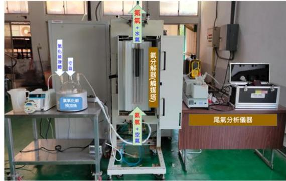
圖 2-14 廢樹脂處理-轉化程序-氨分解觸媒試驗
