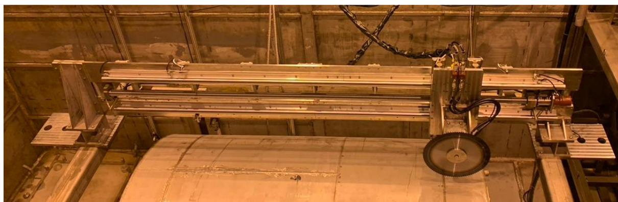
圖 2-2 完成 TRR 內部組件反應槽軸向切割機具製作
