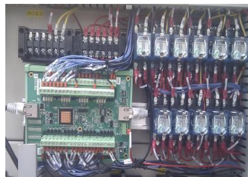
圖 13：負載同步啟停控制面板與 DIO 同步控制器
