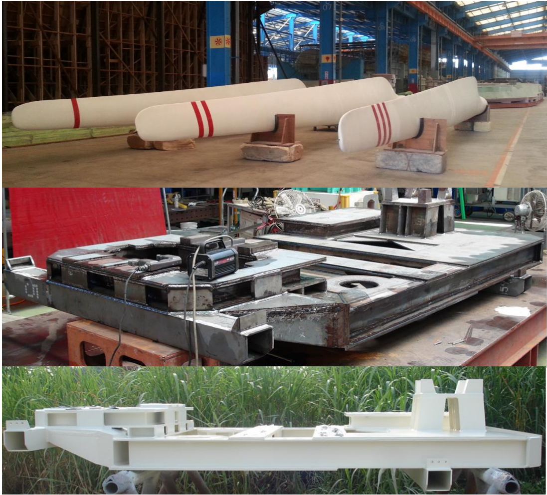
圖 5：第二代 150 kW 風機葉片成品與骨架製作及檢測
