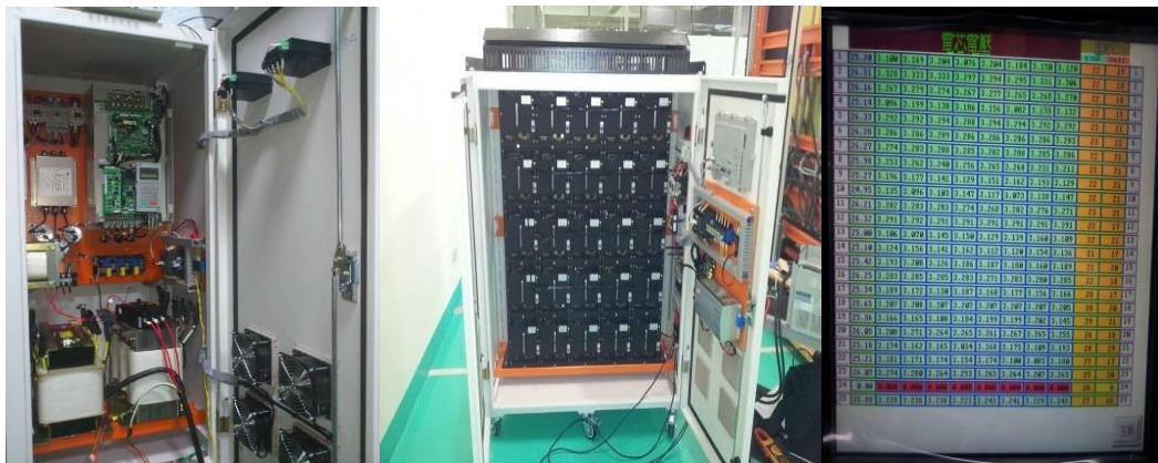
圖 16：三相 15kW 電力轉換器與 14.6kWh 電池管理實體照片
