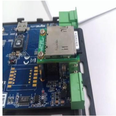
圖 26：微電網控制器 IEEE1588 模組電路修正
