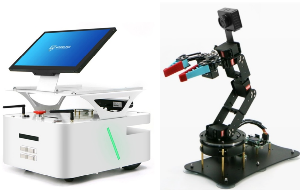
圖 5.3.60:自主巡航機器人與安裝於其上的機器手臂
