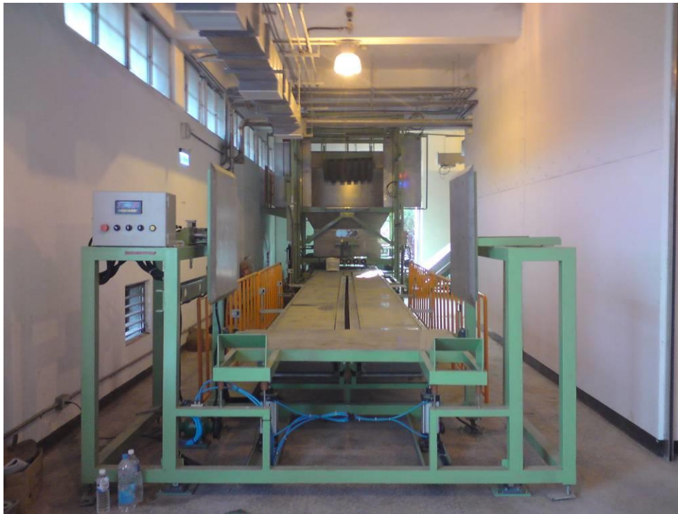
圖 1.3 預處理系統設備(為國內研發設備，此系統可將 1 捆約 250 公斤之稻稈裁切、粉碎至 2cm 左右供後續前處理系統使用)
