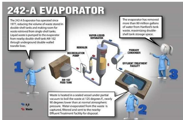
能源部表示 242-A 蒸發器作用在減少 Hanford 地下貯存罐中的液體，藉以減少廢棄物的總量，是 Hanford Site 貯存廢棄物任務的基礎。該升級性能將在 DFLAW 處理方法中發揮重要的作用。自 1977 年建造以來，此設備已從漢福德的貯存罐廢棄物中清除了
