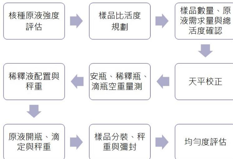
圖 4-35、盲樣射源配置過程
