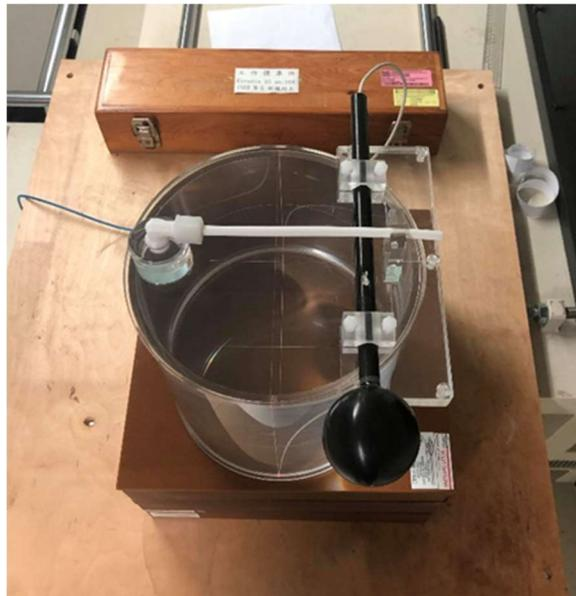
圖 4-39、監測使用之 Exradin A5 游離腔
