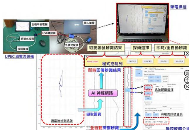
圖 11 可攜式渦電流 AI 即時判讀系統示意圖
