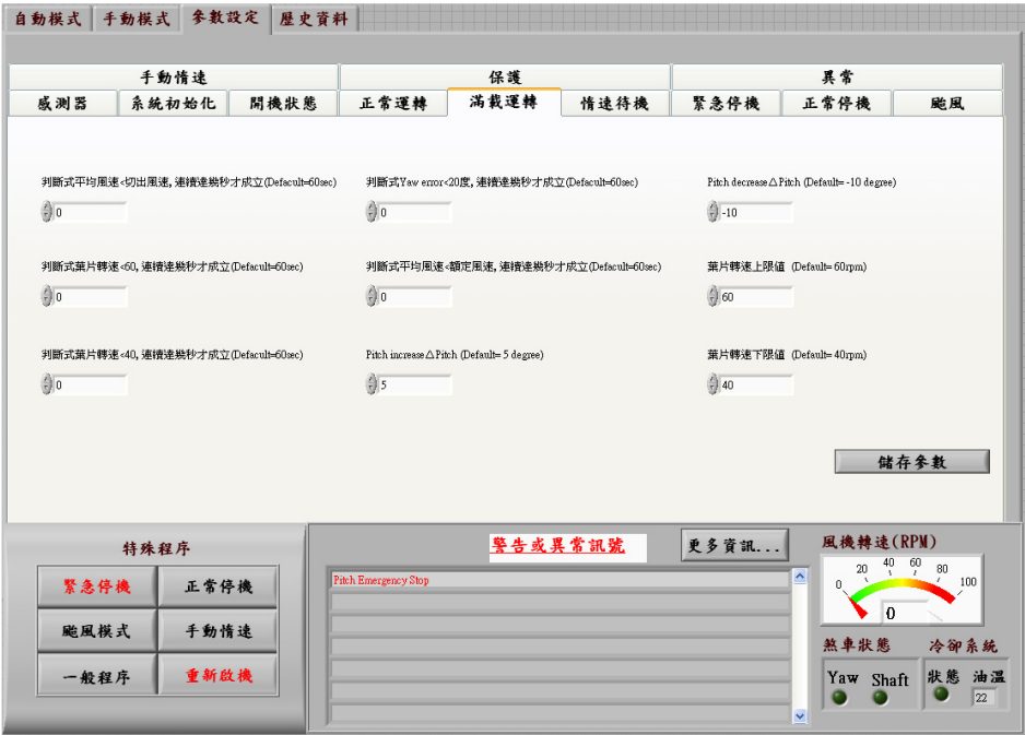
圖 16、監控系統控制策略程式參數模組化介面
