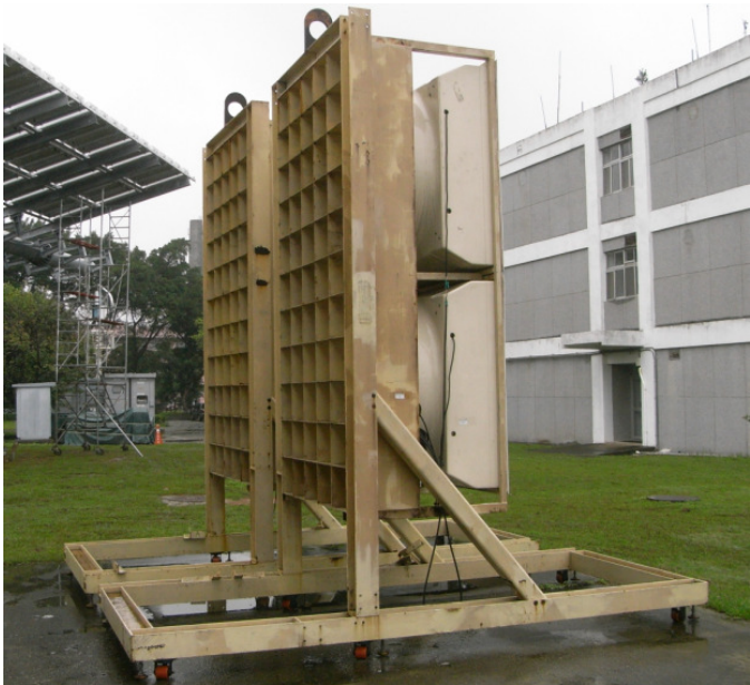
圖 14、小風機性能測試之風牆建置
