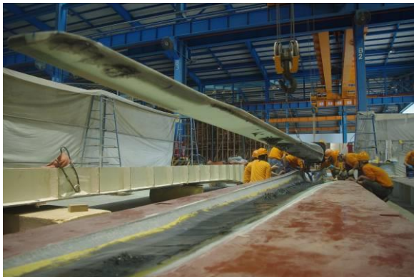
(c) 結構箱型樑與下蒙皮膠合
