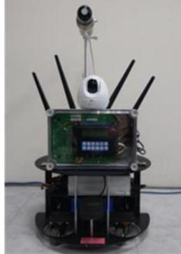
圖 3-4. 輻射偵測機器載具原型機
