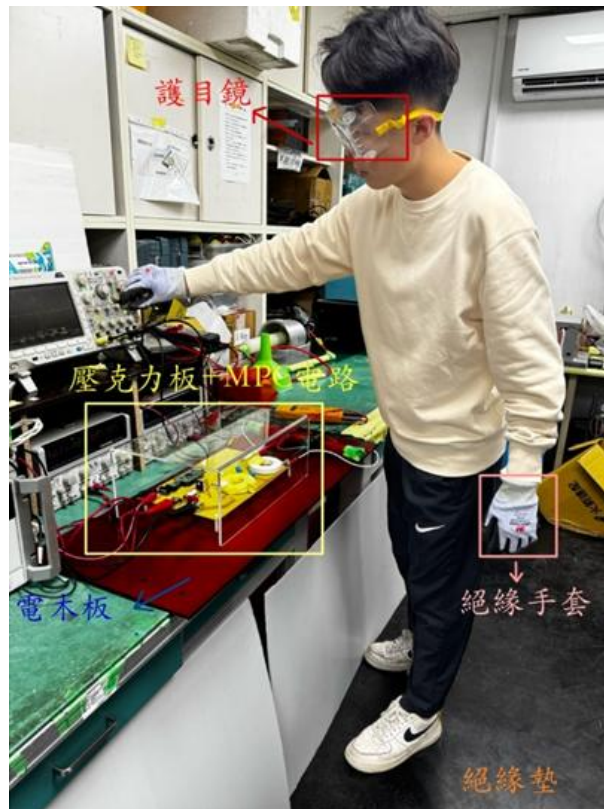
圖 56 磁脈衝電路實體照片(紅色框：電源供應器輸出 200V；黃色框：磁脈衝壓縮電路；綠色框：輸出負載 2kΩ)
