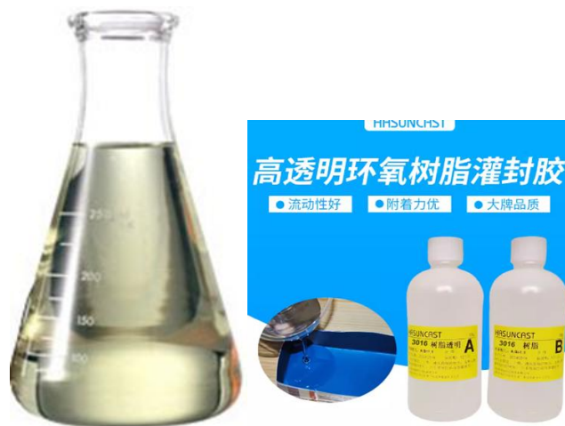
圖 36 絕緣矽油(左)；灌膠用之環氧樹脂(右)
