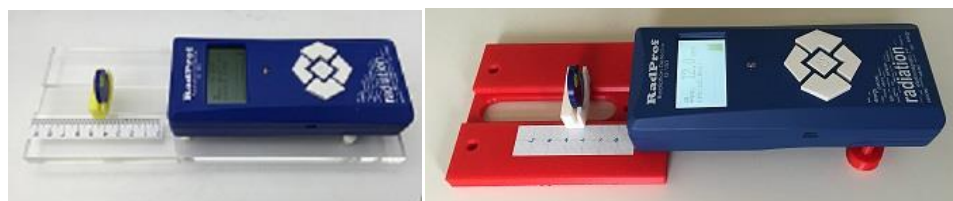
(圖一) 簡易型手持式游離輻射偵測器偵測放射源工作圖
