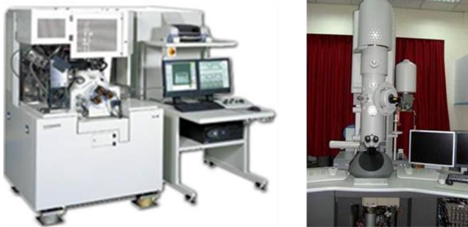
圖 3. (左)聚焦離子束(Focus Ion Beam) (右)穿透式電子顯微鏡
