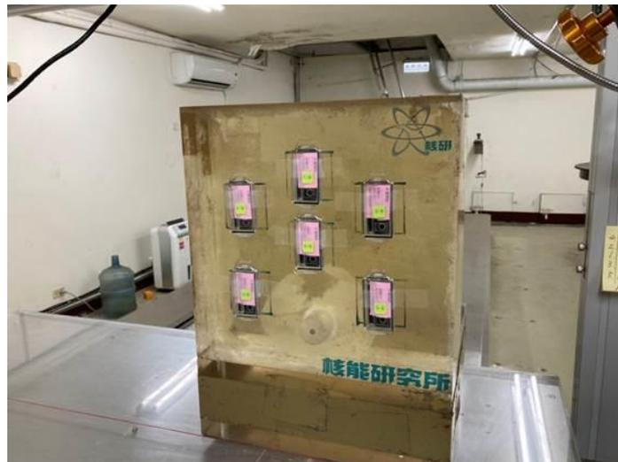
圖 17. 樣本依照國家游離輻射標準實驗室流程進行照射。
