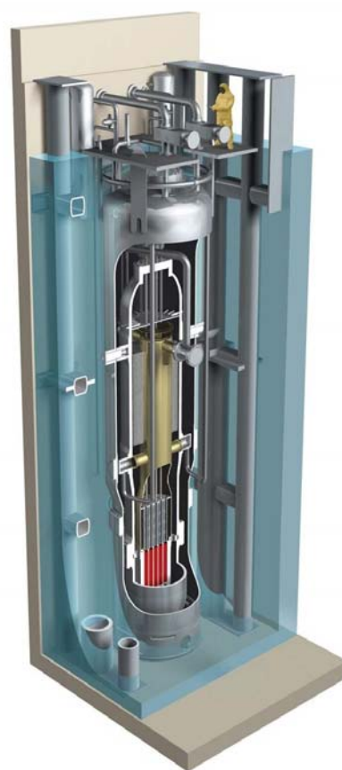
圖 3：NuScale 小型模組化反應器示意圖（資料來源：NuScale power）
