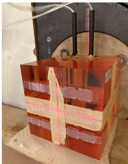
圖 6、CR-39 底片於 PMMA 假體之擺放位置
