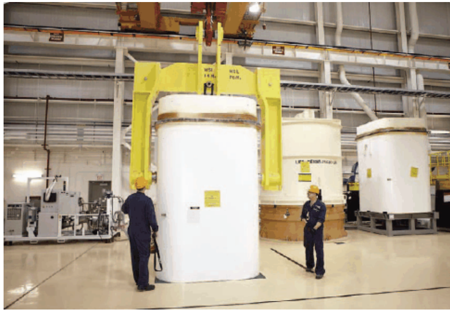
圖 11 Pickring 電廠用過核子燃料重件吊運作業
