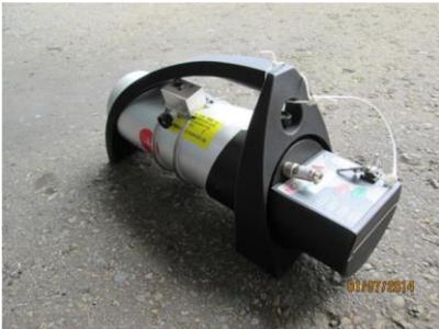
圖 5. 移動型/手持式 X 光檢測儀
