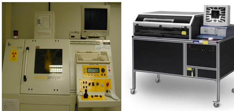
圖 4. 櫃型 X 光機：電子元件檢測 X 光機(左)、半導體封裝檢測 X 光機 (右)
