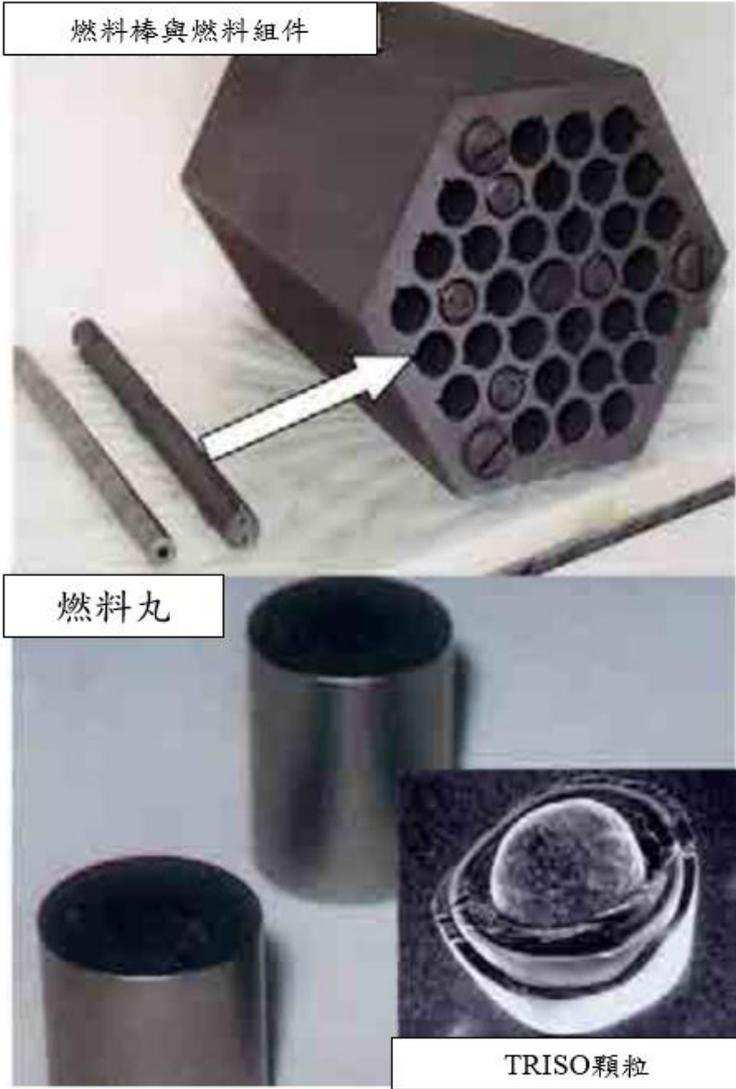
圖 3-11 TRISO 塗層顆粒的棱柱形燃料[43]
