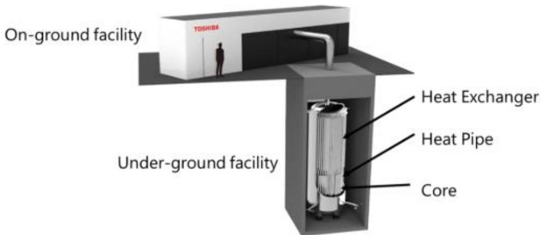
圖 3-19 微型反應器 MMR(MoveluX) [50]
