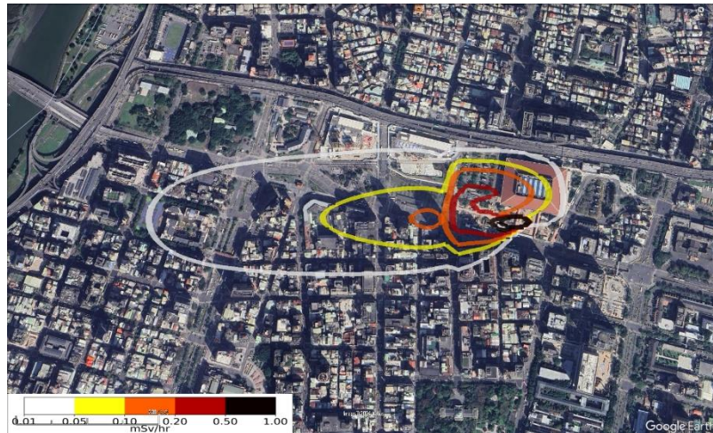
圖四-20 CALPUFF 模擬臺北車站輻射彈事件之空間劑量分布，風向為東風，核種為 Cs-137，15 分鐘累積空間劑量分布(等值線單位為 \text{mSv/hr} )
