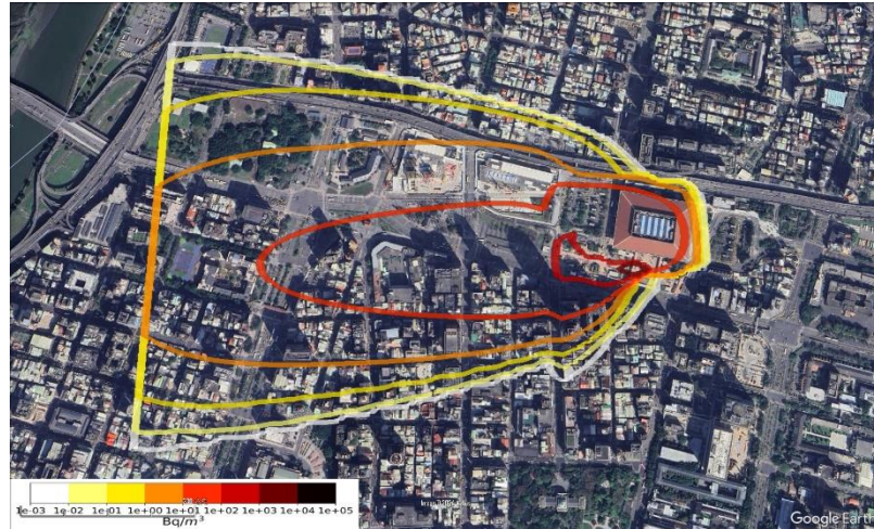
圖四-19 CALPUFF 模擬臺北車站輻射彈事件之空氣濃度分布，風向為東風，核種為 Cs-137，15 分鐘累積柱狀空氣濃度分布(等值線為 \text{Bq/m}^3 )
