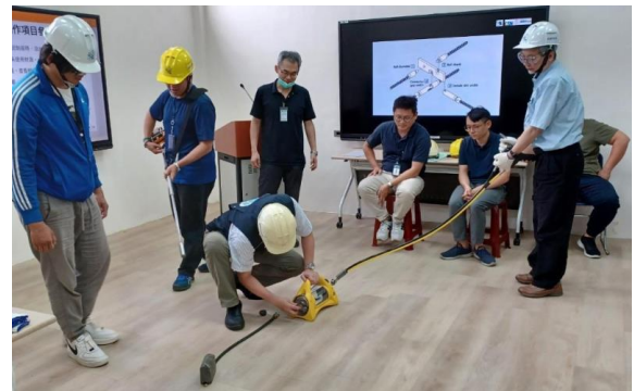
透過控制纜繩搖回射源至儀器屏蔽
