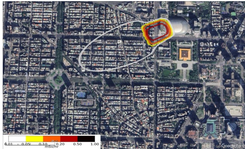
圖四-43 CALPUFF 模擬臺北大巨蛋輻射彈事件之空間劑量分布，風向為東北東風，核種為 Cs-137，15 分鐘累積空間劑量分布(等值線單位為 mSv/hr)
