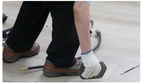
將鉛屏蔽屏蔽覆蓋射源
