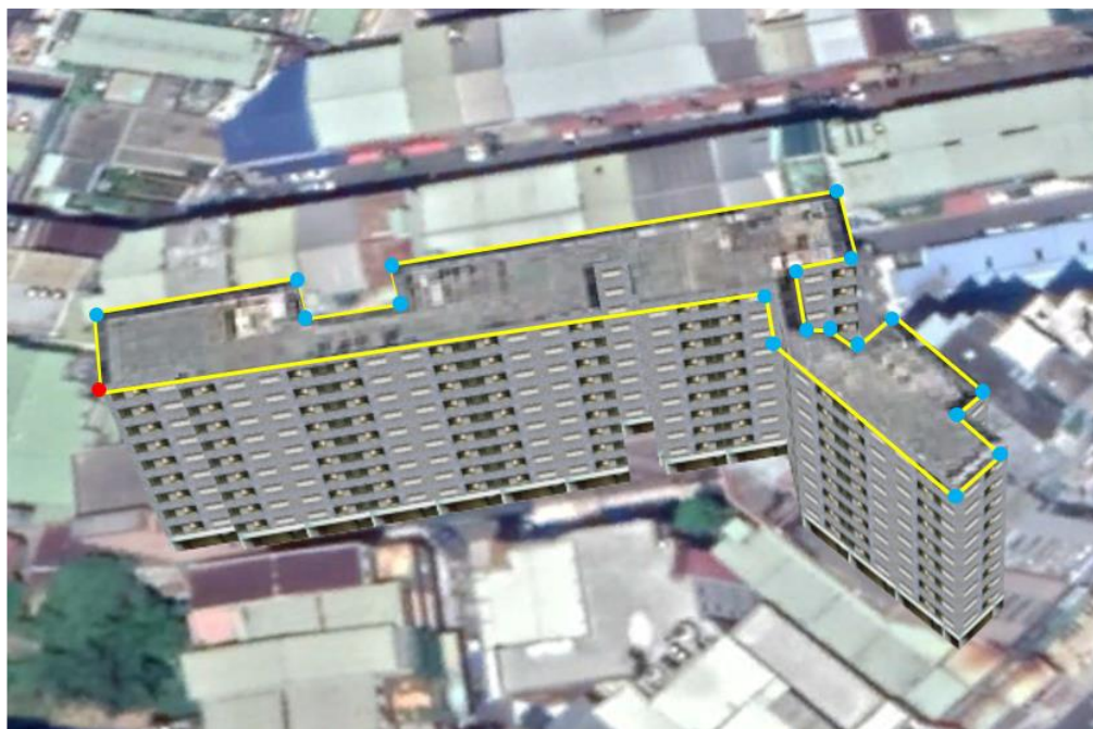
圖四-4 圖土測繪中心 LOD1 建物模型資訊範例圖，該範例建物為 19 點連結之建物輪廓，紅點為定位座標參考點
