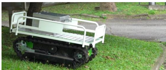
遙控鉛罐車戶外爬坡
