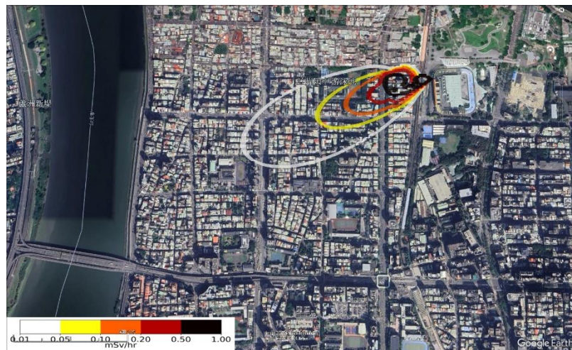
圖四-36 CALPUFF 模擬臺北圓山花博輻射彈事件之空間劑量分布，風向為東北東風，核種為 Cs-137，15 分鐘累積空間劑量分布(等值線 \text{mSv/hr} )
