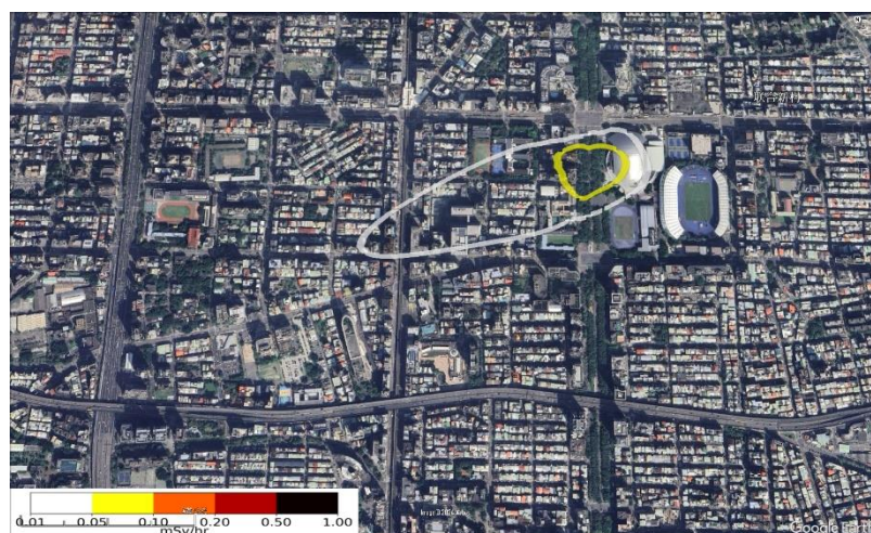
圖四-29 CALPUFF 模擬臺北小巨蛋輻射彈事件之空間劑量分布，風向為東北東風，核種為 Cs-137，15 分鐘累積空間劑量分布(等值線單位為 mSv/hr)
