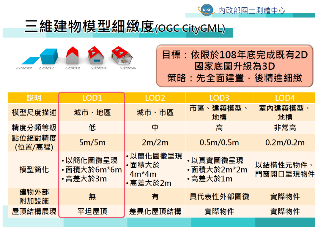
圖四-2 三維建物模型細緻度示意圖，模型細緻度可區分為 4 種等級
