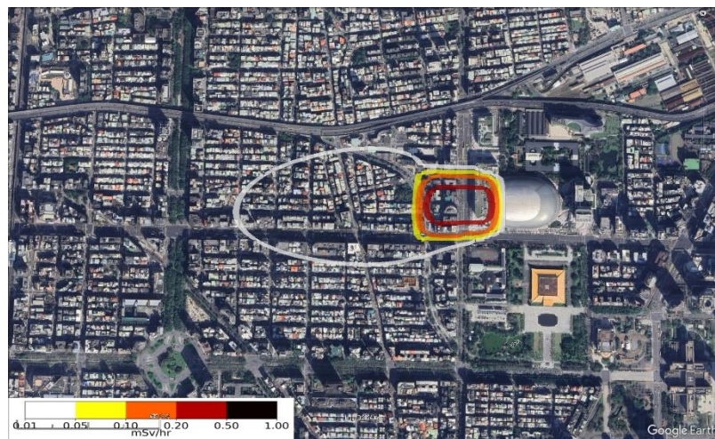
圖四-42 CALPUFF 模擬臺北大巨蛋輻射彈事件之空氣濃度分布，風向為東北東風，核種為 Cs-137，15 分鐘累積柱狀空氣濃度分布(等值線單位為 Bq/m 3 )
