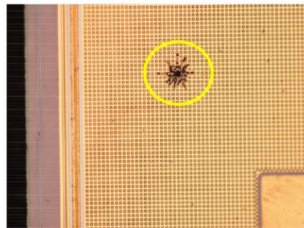
SEB事件損傷情形
