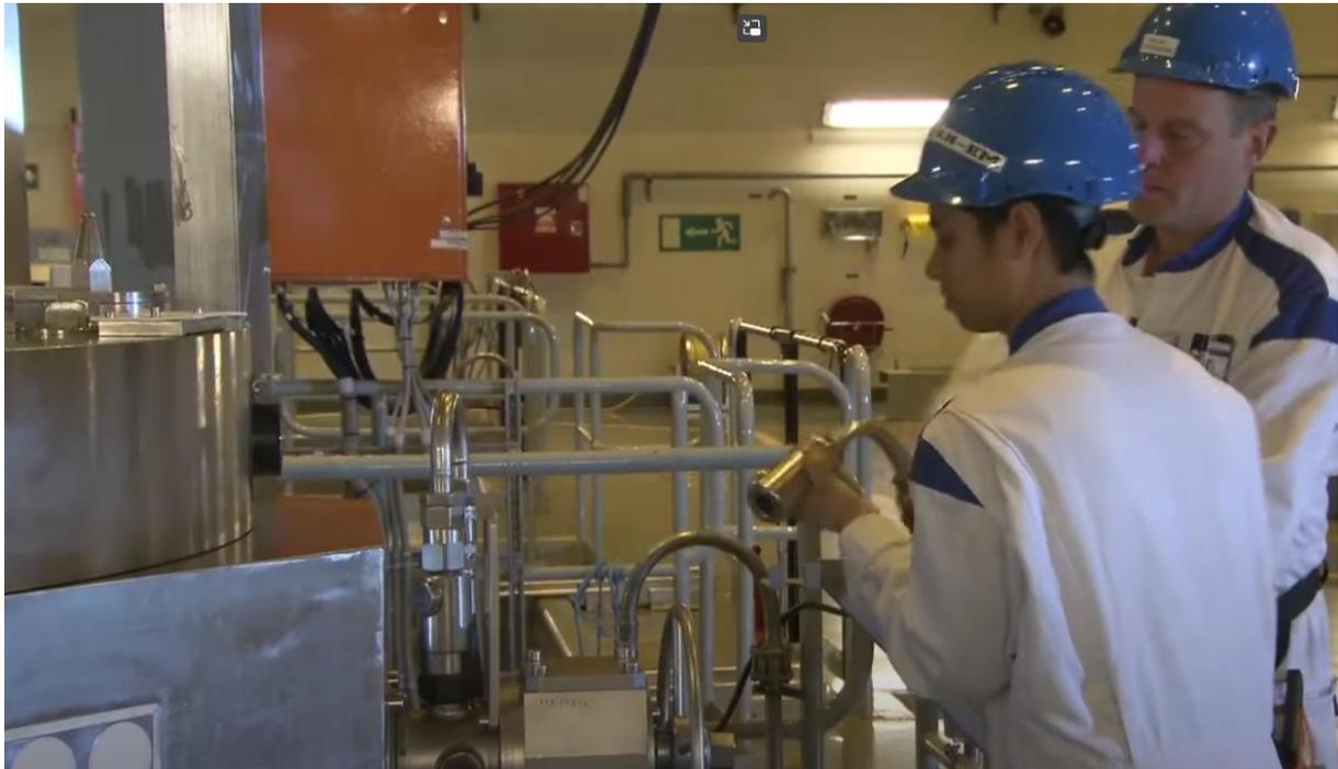
圖 8、SKB 操作人員連結冷卻裝置[7]
