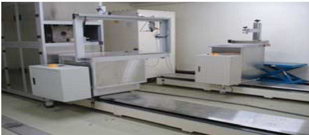
圖 8 高強度 Cs-137 射源照射校正器
